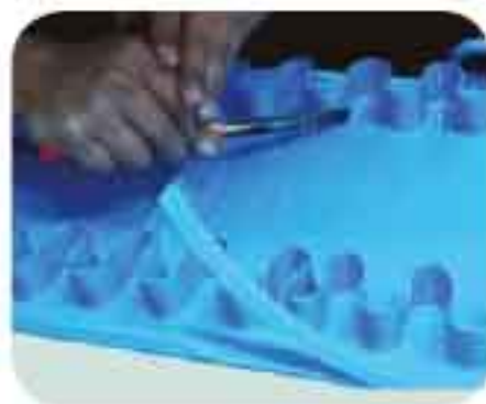
Endlos verschweißen von Wellenkanten und Stollen
